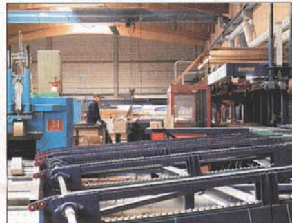
Holzbauteile werden in der klimatisierten Abtundhalle vorfertigt.
