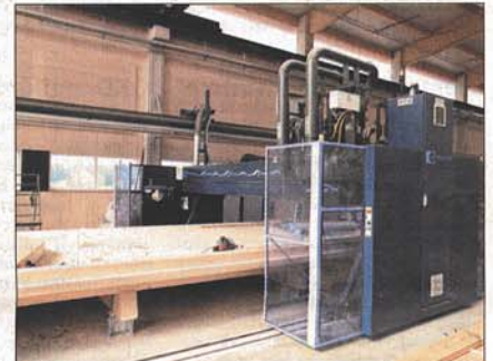
Jüngste Großinvestition: eine automatische Bearbeitungsbrücke für flächige Bauteile.
